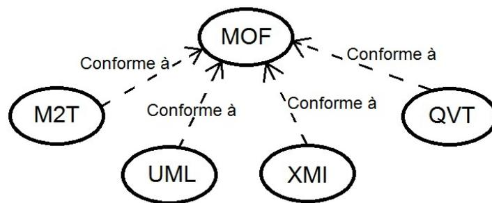
FIGURE 3.3 – Conformité des Standards OMG à MOF
