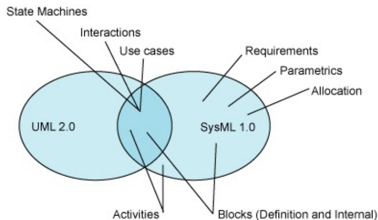
FIGURE 2.4 – Réutilisation des diagrammes UML 2.0 dans SysML 1.0
