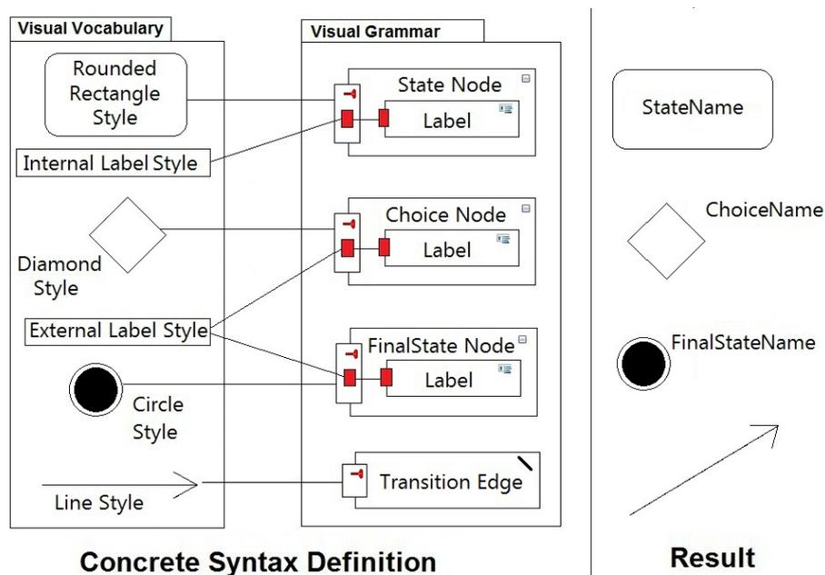
FIGURE 8.5 – Spécification des éléments graphiques du diagramme d'états-transitions
