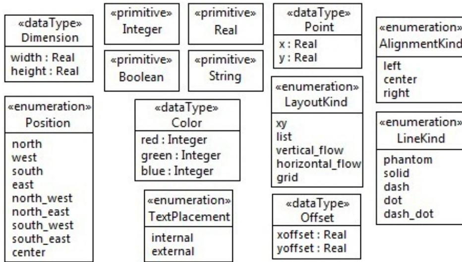
FIGURE 7.2 – Éléments communs : Type de données et primitives
