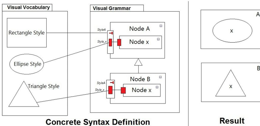
FIGURE 7.26 – Spécialisation d'une caractéristique : redéfinition du style
