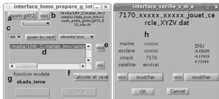
Figure 12.5 – Interface de préparation de G\_interf a : ouverture d’une structure de données G\_XYZ ; b : module de contrôle de G\_XYZ ; c : format des données d’observation et recherche; d : liste des données sous-échantillonnées prises en compte; e : visualisation des données sous-échantillonnées; f : lancement de la préparation; g : nom du modèle de déformation utilisé pour G\_interf ; h : module de contrôle des paramètres de l’interférogramme. Ce module ne s’ouvre que lorsque le calcul est terminé. Il permet de modifier le s\_m\_e de l’interférogramme ainsi que la ligne de visée.
