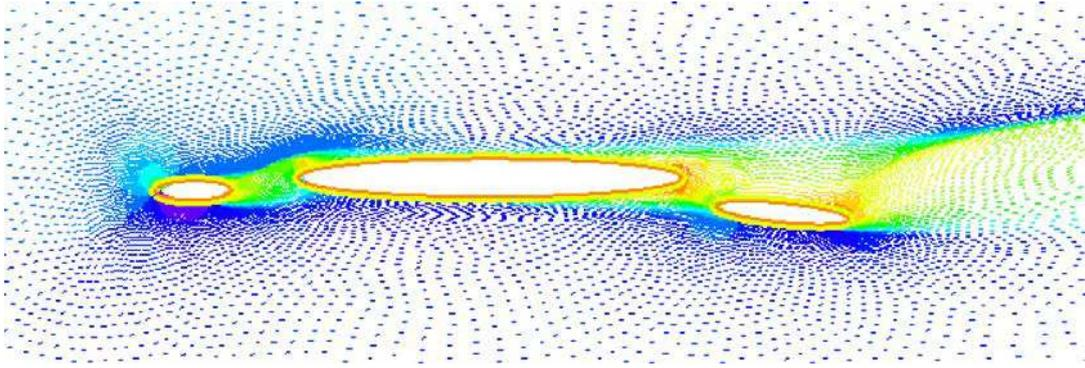
**FIGURE 3.5:** Champ de vitesse au voisinage des ellipses à  $R_e = 100$
