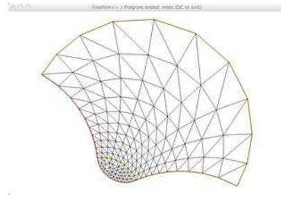
FIGURE 1.3: Maillage déformé par inversion et rotation.
