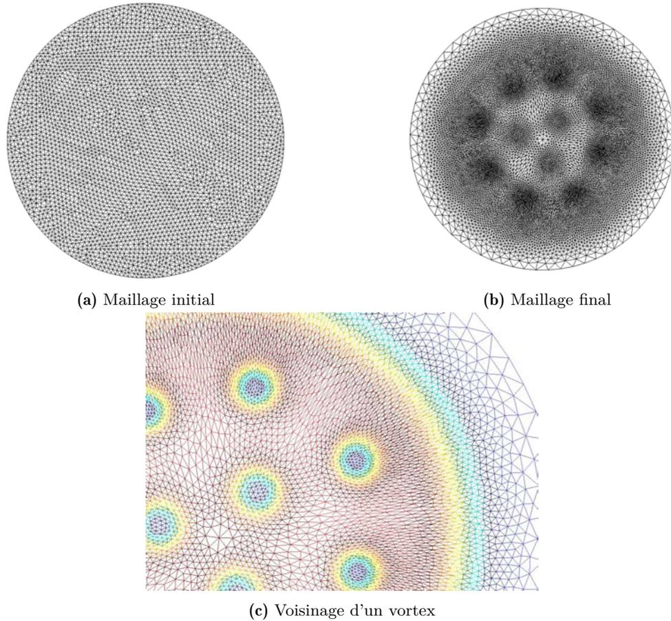
**FIGURE 3.10:** Maillage 2D initial et maillage final pour  $g = 500$  et  $\Omega = 2$
