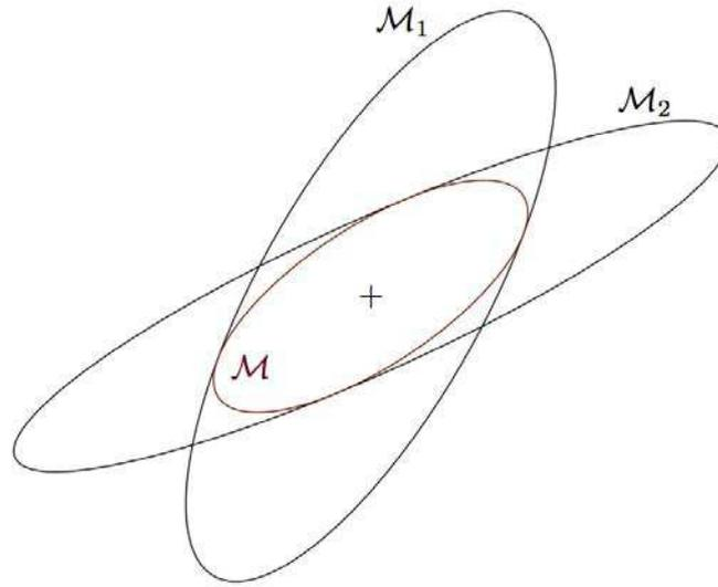
FIGURE 1.6: Intersection de deux métriques en 2D
