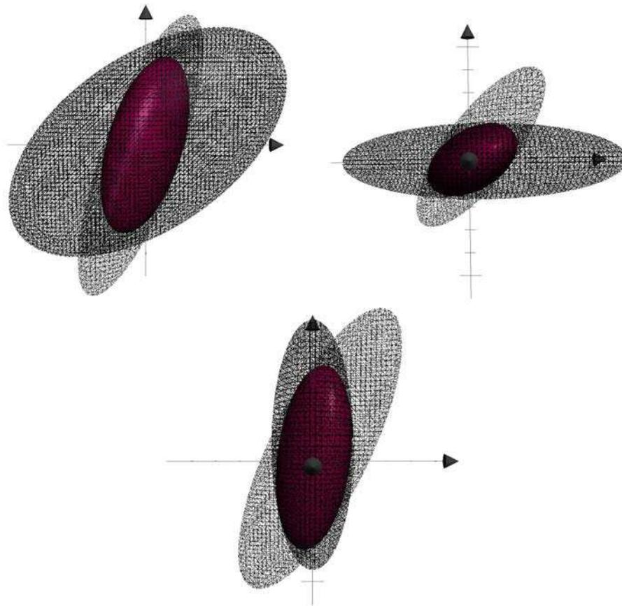
FIGURE 1.7: Intersection de deux métriques en dimension 3 - vue depuis différentes directions
