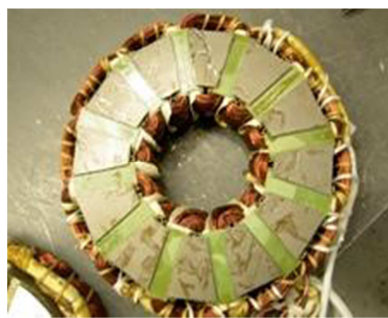
(b) Stator à bobinage concentré
