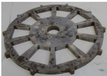
(a) Structure du rotor sans aimants
