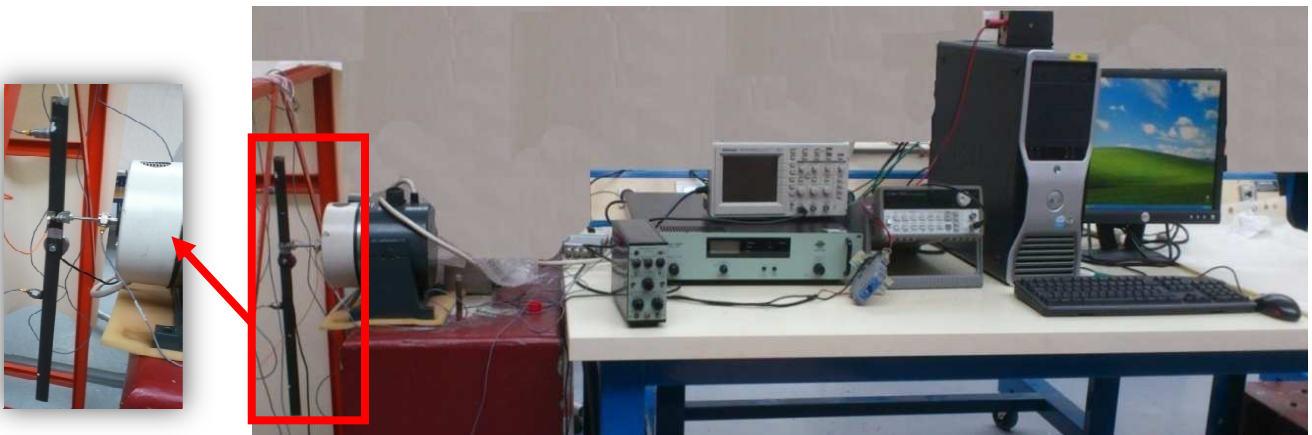
Figure 28. Dispositif expérimental des essais de torsion dynamique.
