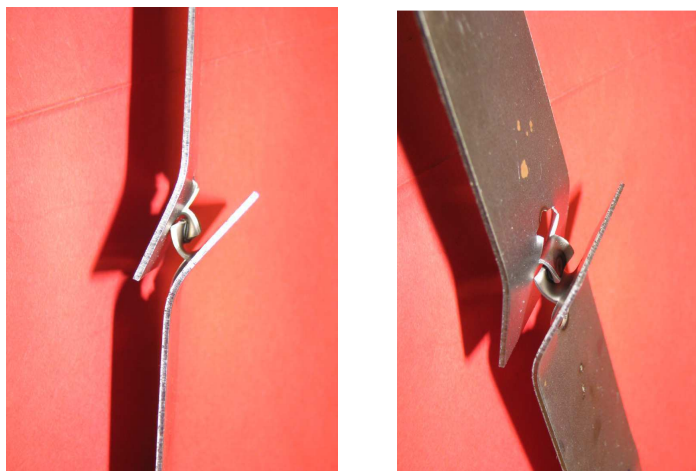
Figure 2.10 – Rupture (par déchirement des tôles) de l'éprouvette soudée par point sans raidisseur
