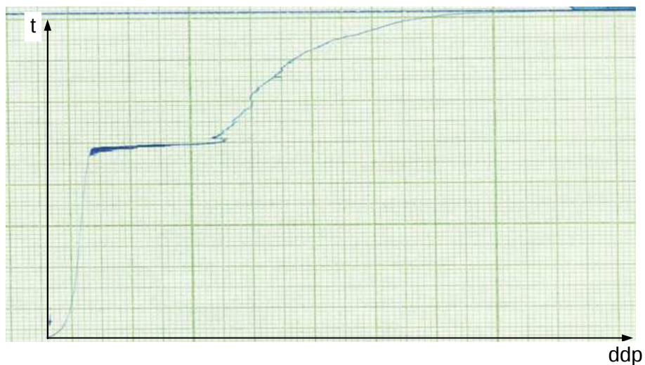
Figure 2.19 – Evolution de la ddp u_1-u_4 enregistrée au cours d'un essai de fatigue pour une éprouvette munie du raidisseur
