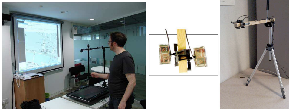
FIGURE 8.13 – Carte projetée sur le mur et affichée sur un écran plat (à gauche) et détail sur le dispositif de capture de la position du doigt, formé de deux caméras trackIR (à droite) dans la version 4 du prototype multimodal GEI.
