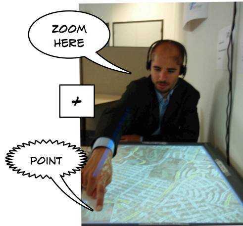
FIGURE 4.26 – Système interactif utilisé pour illustrer notre modèle. Le système utilise une table tactile et un système de reconnaissance vocale.
