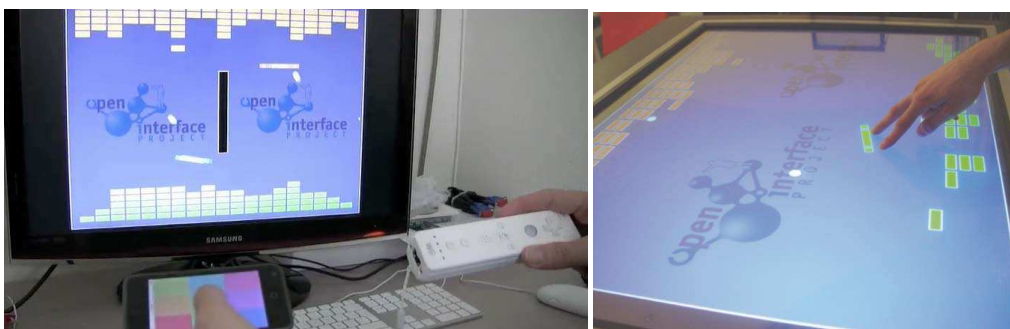
FIGURE 8.38 – Interaction multimodale avec iPhone et Wiimote (à gauche) et interaction de type manipulation directe sur une table tactile (à droite).
