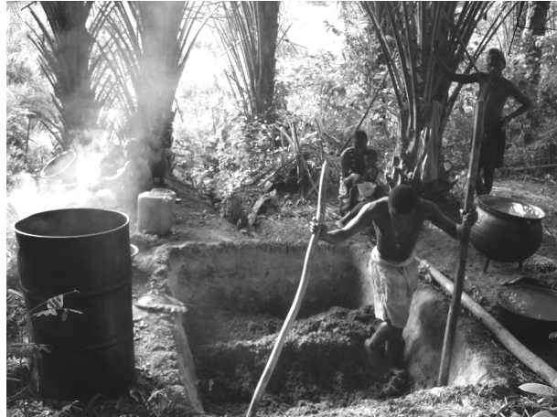
Fig. 80: Foulage des drupes au pied pour l'extraction de l'huile de palme L'eau est ensuite versé dans la fosse, pour lequel est prévu une évacuation. L'huile est récupérée à la surface avant la seconde cuisson. L'utilisation d'une fosse implique l'accès à un fût métallique pour « cuire » suffisamment de drupes en une fois.
