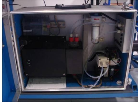
Figure 3-3. Sécheur composé d'un group froid à effet Peltier
