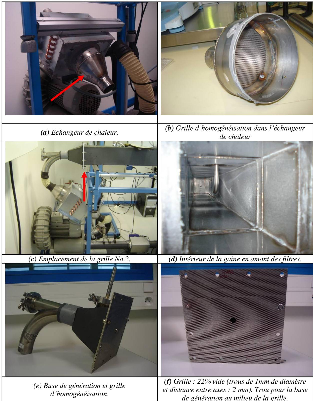
**Figure A3 - 6.** Emplacement des deux grilles d'homogénéisation : l'une dans l'échangeur de chaleur et l'autre en aval du coude de la génération de particules.
