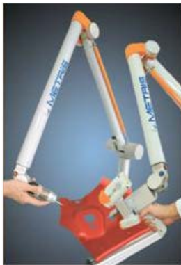
(a) Bras de mesure par coordonnées Metris MCA.
