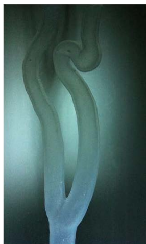
FIGURE 2.36 – Modèle silicone transparent de carotide obtenu avec le moule multi-pièces
