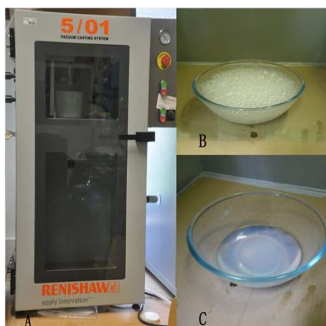
FIGURE 2.33 – A. Machine de pompe à vide B. Dégazage en cours C. RTV 3040A après le dégazage
