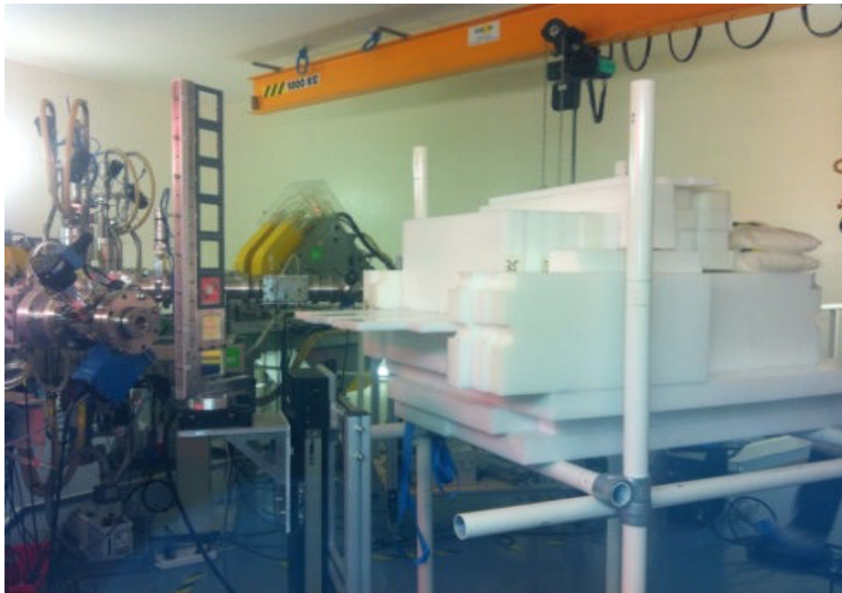
Figure 33 : le détecteur de rayons gamma entouré par les briques de plomb et les blocs de paraffine
