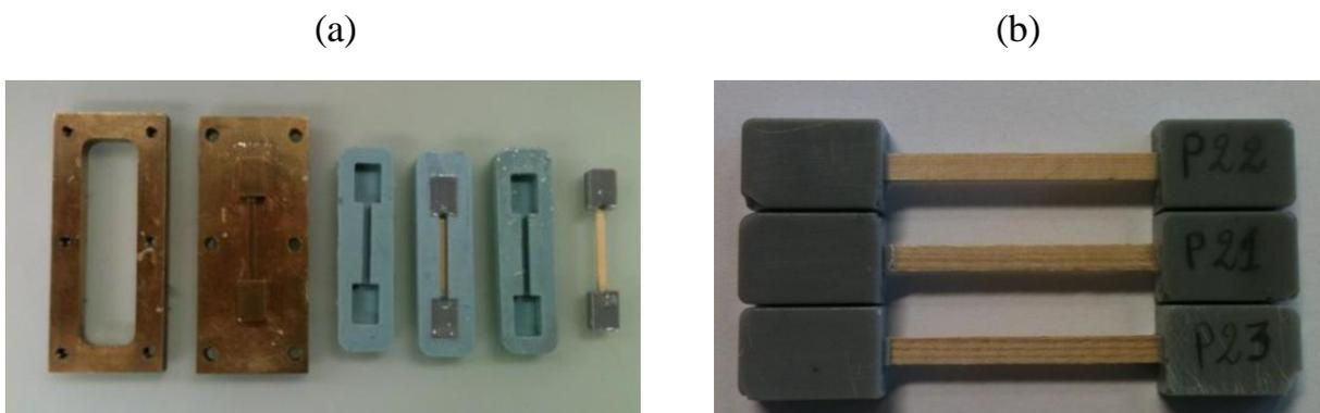
Figure 3-5 : Préparation des échantillons (a) ; Echantillons préparés (b).
