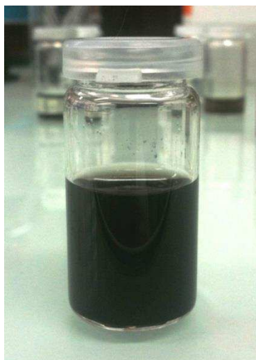
Figure II-8 : Une suspension des nanofils de cobalt dispersés dans le chloroforme (0.5% w.t.)
