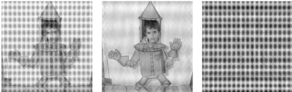
FIGURE 7.2 – A gauche l’image originale, au centre première composante morphologique (extraite dans une trame de curvelette), à droite seconde composante morphologique (extraite dans une base de cosinus engendrée par la transformée en cosinus discrète). Source : [Bobin et al., 2007].
