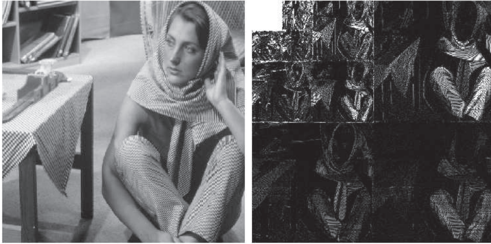
FIGURE 2.10 – A gauche, l'image originale. A droite, la valeur absolue des coefficients d'ondelettes (allant de 0 (noir) à 100 (blanc)). L'échelle a été choisie afin de pouvoir visualiser les coefficients correspondants aux détails fins. Ici, la base d'ondelettes choisie est celle de Daubechies à 4 moments nuls.
