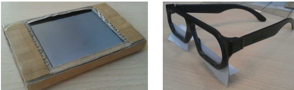
FIGURE 2.1 – À gauche, le cache en carton épais recouvrant l'iPod Touch empêche la détection des événements en dehors de la zone visible. À droite, les œillères ont été fabriquées à partir de lunettes en plastique auxquelles sont scotchés des caches en papier cachant la moitié basse du champ de vision.
