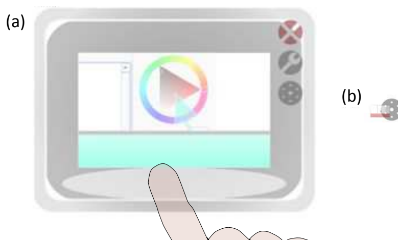
FIGURE 4.10 – (a) Affichage étendu d’un WallPad, les bordures sont agrandies après avoir pressé le bouton « clé à molette ». Les bordures permettent de déplacer et redimensionner le widget. (b) Vue réduite de WallPad avec le bouton de minimisation.
