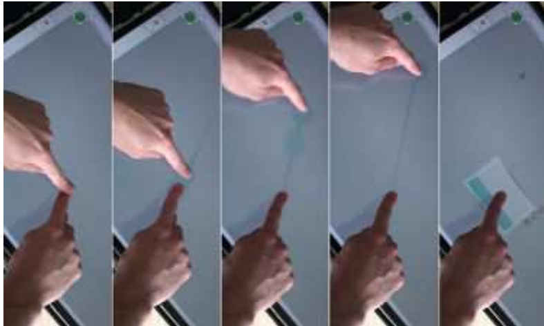
FIGURE 4.9 – Création d’un WallPad, capturé ici sur un écran multi-points 3M pour plus de visibilité. De gauche à droite : un doigt glisse le long d’un autre doigt qui reste immobile et continue le mouvement sur l’écran jusqu’à dépasser un seuil pour créer un WallPad. Le feedback et le feed-forward signale la reconnaissance du geste et informe de la validité de la création et du lieu d’apparition du curseur.
