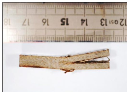
c) Sergé 2/2 de basalte + porosité inter-plis (45 mm)
