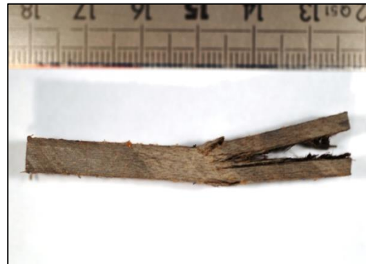
b) Sergé 2/2 de basalte + porosité inter-plis (55 mm)
