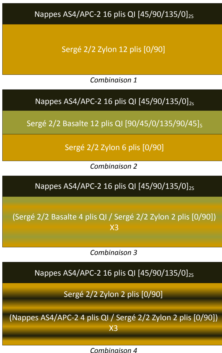
Figure 6.2 : Représentation schématique des différentes configurations multimatériaux testées
