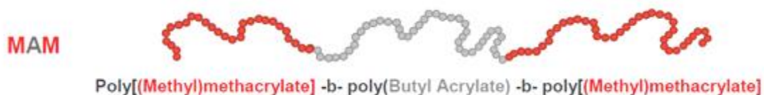
Figure 1.26 : Schéma d'un copolymère tribloc (Nanostrength®) d'Arkema [57]
