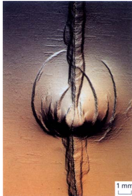
Figure I.21 : Fissure de fatigue sur un acier doux interrompue par une surcharge, puis reprise avec la charge initiale (progression de bas en haut). D'après Pokorny (2003).
