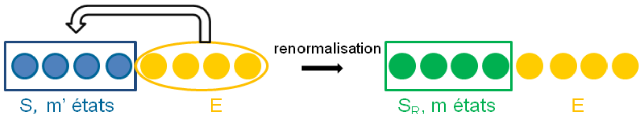
Schéma 2.10 Renormalisation (ou sélection d'états) du système ( S ) en système S_R . On a m < m' . Cette renormalisation est effectuée à partir de la projection de l'environnement ( E ) sur S grâce à la matrice densité réduite. Cette projection est dénotée par la flèche courbe. Le processus permet de conserver les m états les plus « proches » de l'état recherché.
