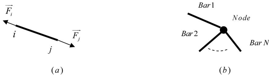
**Figure 75.** Equilibre d'une structure de poutres (a) équilibre d'une poutre (b) Equilibre d'un nœud
