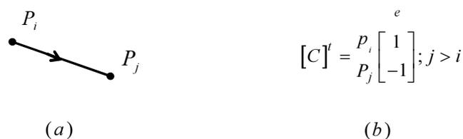
**Figure 76.** Élément de barre (a) graphe topologique (b) matrice d'incidence
