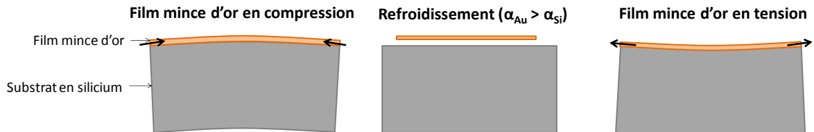
Figure 21 : Représentation schématique de l'évolution de la courbure et de la contrainte dans un film mince d'or lors de la descente en température.
