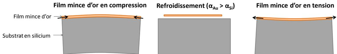
Figure 21 : Représentation schématique de l'évolution de la courbure et de la contrainte dans un film mince d'or lors de la descente en température.
