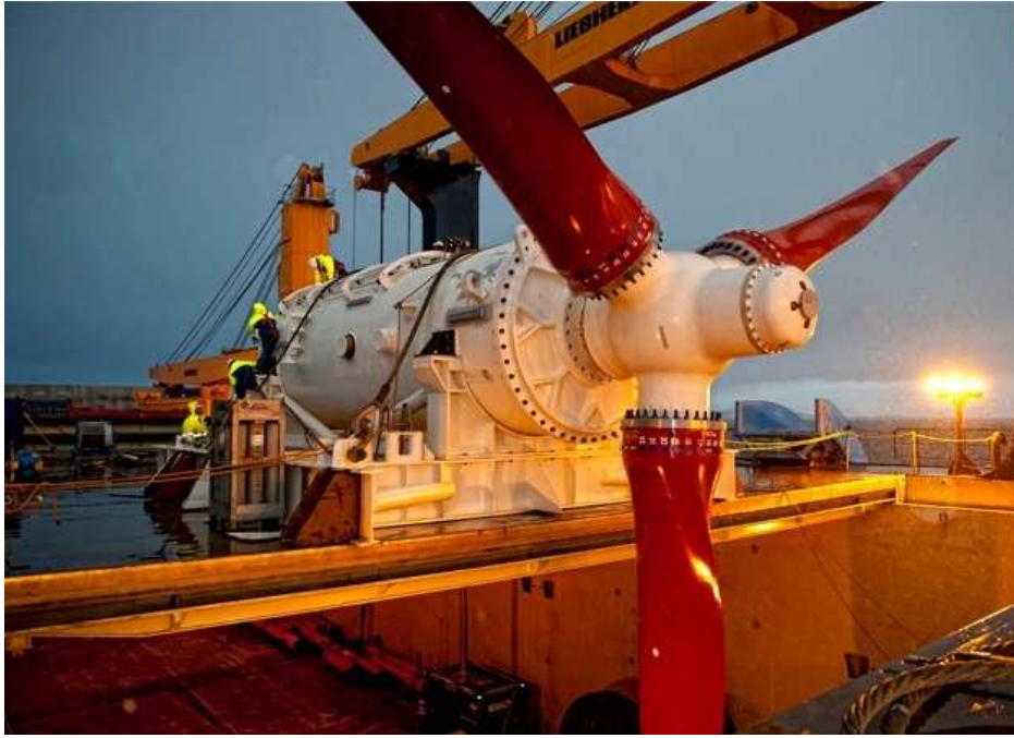
Fig. I.2. Andritz Hydro Hammerfest HS1000 turbine [13].
