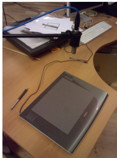
FIGURE 2.1 – Dispositif utilisé pour enregistrer les sons et les profils de vitesse produit par le scripteur
