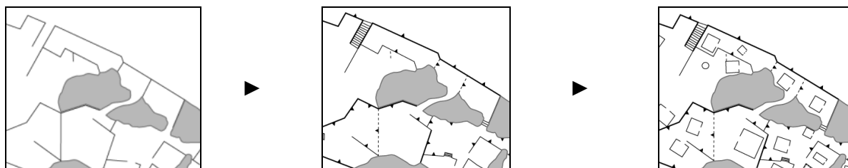
Figure 30 : Les trois étapes de relevés au GPS : système d'aménagement (1), de circulation (2), bâti (3).
