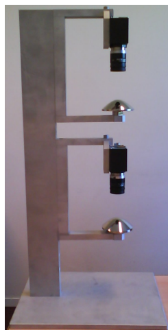
FIGURE 1.12 – Capteur stéréo-catadioptrique utilisé pour nos travaux
