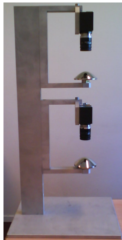
FIGURE 1.12 – Capteur stéréo-catadioptrique utilisé pour nos travaux
