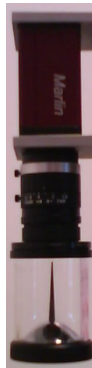
FIGURE 1.9 – Caméra catadioptrique à cy- lindre de verre
