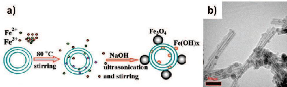
Figure 61. a) Schéma de fabrication et b) Cliché MET des nanotubes-Fe<sub>3</sub>O<sub>4</sub> selon (Niu et al. 2010)
