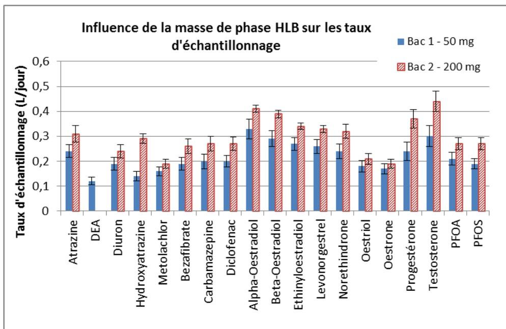
Figure 49 - Taux d'échantillonnage obtenus avec 50 et 200 mg de phase Oasis HLB (n = 3)
