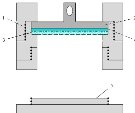
Figure 10 - Echantillonneur de type Chemcatcher<sup>®</sup> (Vrana et al. 2006)
