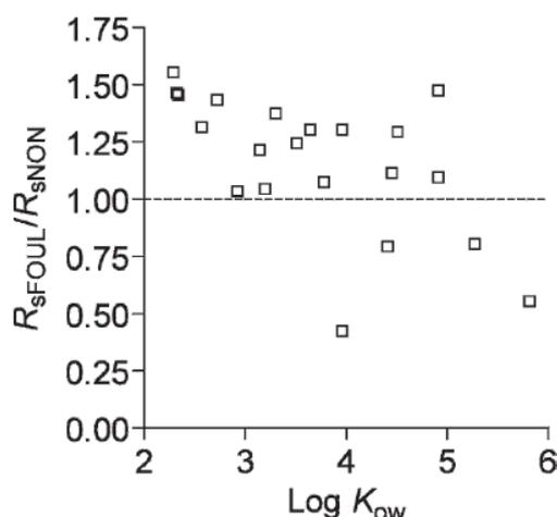
Figure 17 - Rapports entre les taux d'échantillonnage d'alkylphénols obtenus avec des membranes biofoulées et neuves (Harman et al. 2009)
