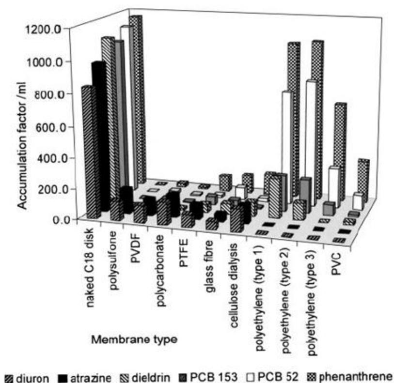
Figure 12 - Effet de la nature de la membrane sur l'accumulation de composés organiques dans la phase réceptrice du Chemcatcher<sup>®</sup> (Kingston et al. 2000)
