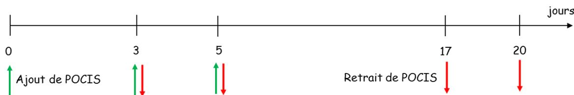
Figure 36 - Planning classiquement suivi pour les calibrations en laboratoire et sur pilote
