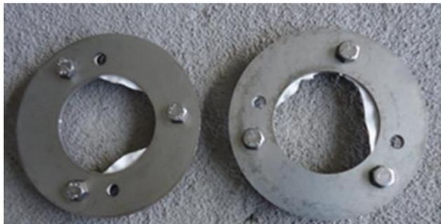
Figure 52 - Etat des membranes de POCIS après trois jours d'exposition dans l'effluent de la STEP B
