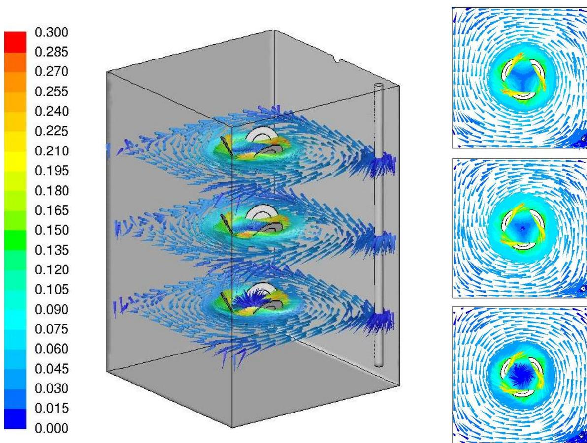
Figure 47 - Profils des vecteurs vitesse colorés par la vitesse (m/s) sur 3 niveaux horizontaux à 33 rpm (à gauche : vue d'ensemble, à droite : vue en coupe de chaque niveau)
