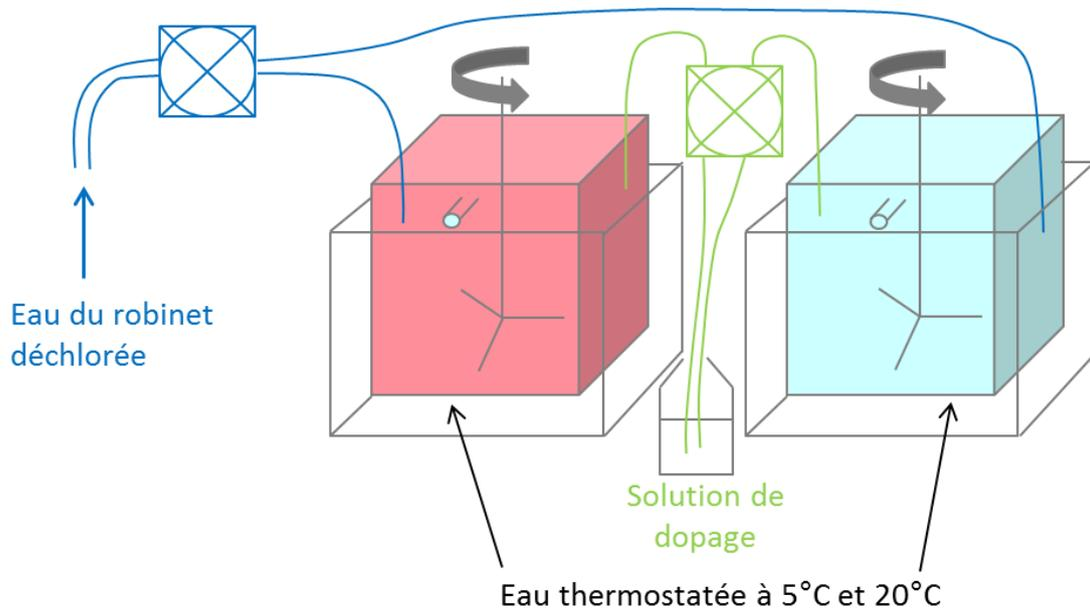
Figure 42 - Schéma du dispositif expérimental utilisé pour étudier l'influence de la température sur les taux d'échantillonnage
