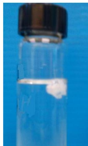
**Figure 30 - Membrane en polycarbonate en présence d'acétonitrile**
