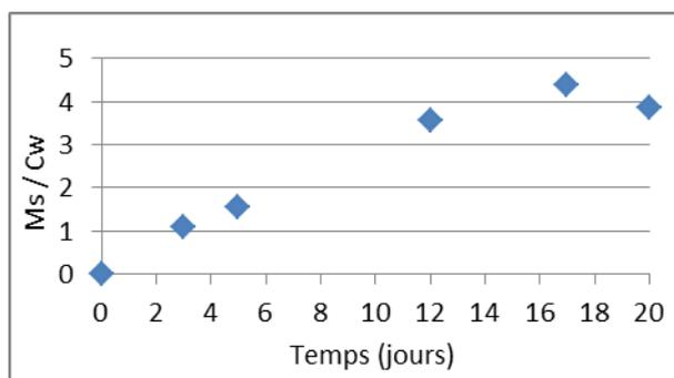
Figure 55 - Accumulation du diclofénac dans des POCIS exposés dans de l'eau filtrée sur sable dopée à 1 µg/L
