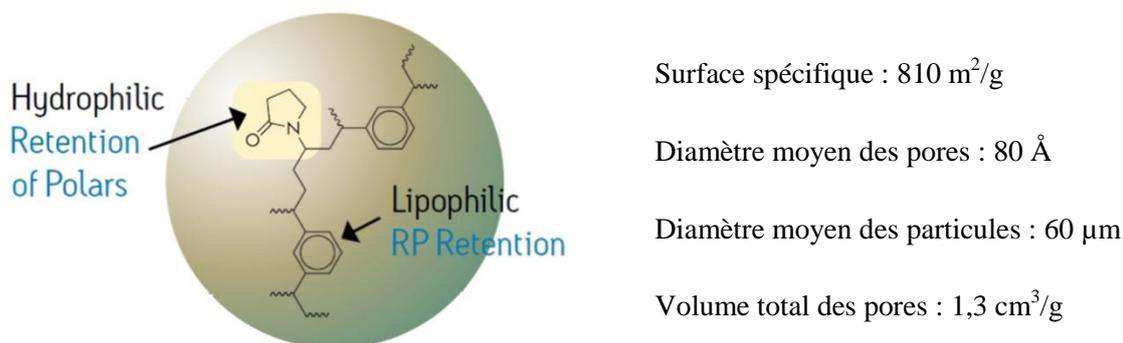
Figure 14 - Structure moléculaire et spécifications de la phase Oasis HLB ([www.waters.com](http://www.waters.com))
