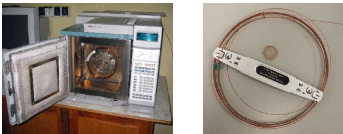
FIGURE 1.7 – Un chromatographe classique de taille moyenne (gauche) et une colonne de séparation standard Varian CP-SIL (droite)
