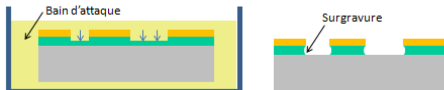
FIGURE 3.4 – Gravure humide d'un wafer (gauche) et résultat après surgravure (droite)
