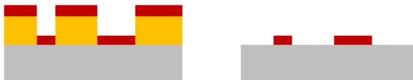
FIGURE 3.6 – Procédé lift-off avant et après retrait de la résine
