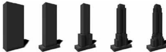
FIGURE 3.9 – Cinq étapes de l’algorithme de génération de bâtiments basé sur les L-systems. L’objet initial est la boîte englobante. L’algorithme génère plusieurs niveaux de détail (Parish et Müller, 2001).
