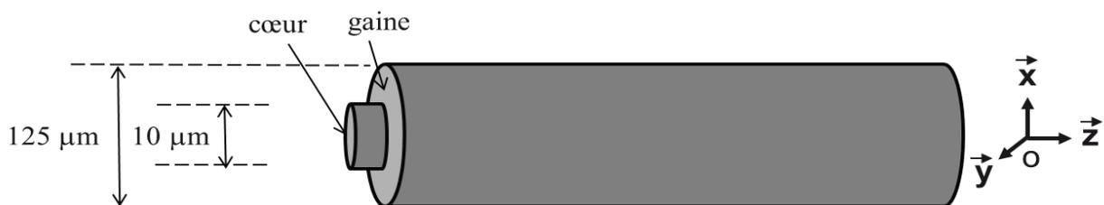
Fig I.5.1.1 : Schéma décrivant une fibre optique
