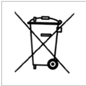
**Figure 18 : pictogramme officiel pour un équipement électrique et électronique.**
