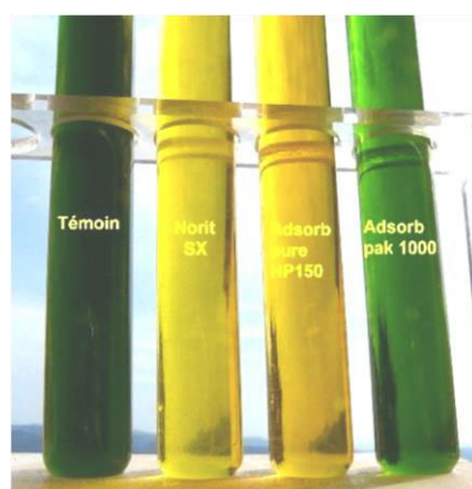
Figure 29 : photo des essais de décoloration de l'extrait de plante A à partir de trois charbons actifs.
