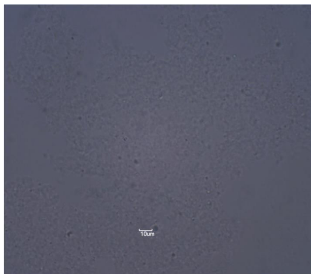
Figure 78 : photos au microscope optique de dispersions de vésicules de composition lipides/solution aqueuse 55 : 45, la solution aqueuse contenant les MCI et MI à 1,13 et 0,37 % respectivement
