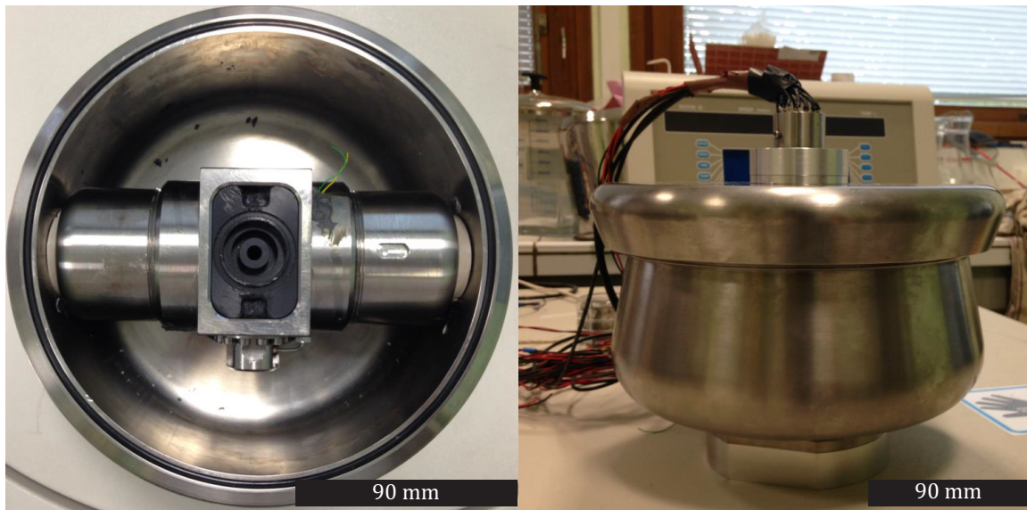
FIGURE 4.2 – Rotor Beckman-Coulter JCF-Z capable d’atteindre des vitesses de 20000 RPM. A l’intérieur du rotor, il y a une cellule et son contrepoids fixés au support central. Au-dessus du couvercle, un collecteur tournant Michigan Scientific S10 permet la transmission des données vers les cartes d’acquisition grâce à ces 10 voies.
