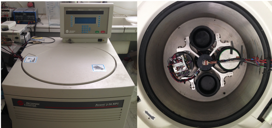
FIGURE 2.3 – A gauche, la centrifugeuse Beckman J-26 XPI . A droite, une vue du rotor composé de 4 godets dont deux vides. Les deux autres contiennent la cellule expérimentale et le contreponds. Un collecteur tournant avec 10 voies permet de connecter la cellule aux cartes d’acquisition.
