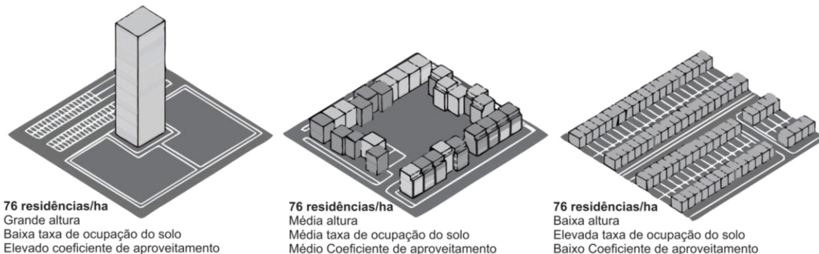
Figura 75: três formas urbanas diferentes para densidades idênticas . Fonte : Adaptado de Moulinié e Naudinadam (2005).
