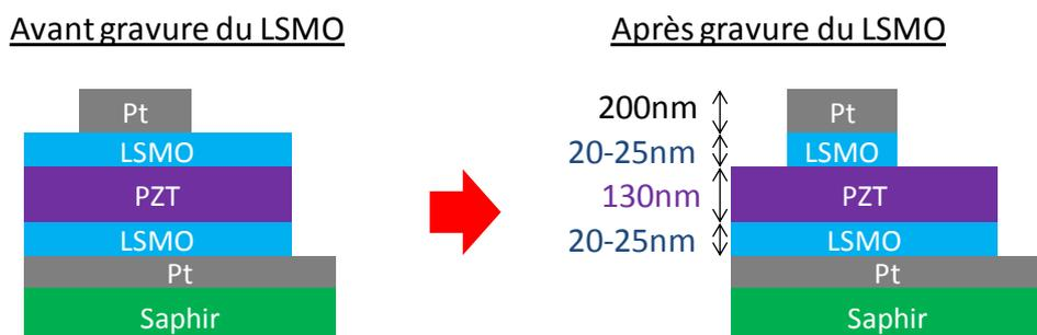
Figure 4.38 : Schéma de l'hétérostructure Pt/LSMO/PZT/LSMO/Pt/Saphir avant et après gravure de la couche de LSMO supérieure.
