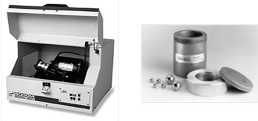
Figure 26 - Broyeur vibratoire Spex 8000M et creuset de broyage
