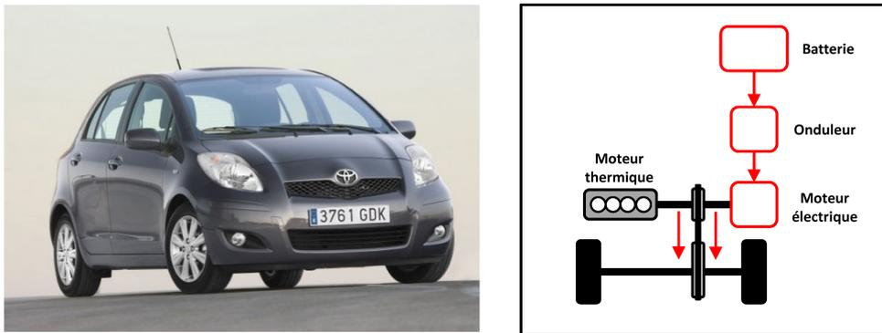
FIGURE 1.9 – Toyota Yaris équipée du système Micro Hybride avec système Stop & Start (Moteur essence 100Ch, moteur électrique 74kW)
