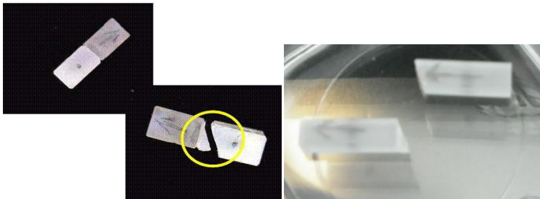
Figure 3.8 : Assemblages KTP/KTP qui ont rompu. La zone de fracture se situe au sein d'un des deux cristaux de KTP. L'interface collée a résisté
