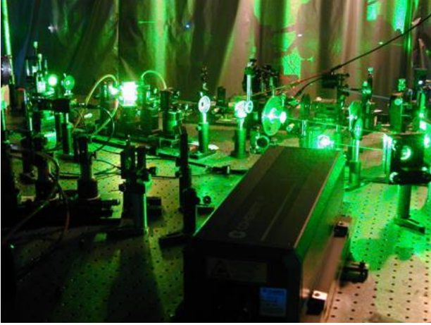
Figure 1.5 : A gauche une table optique avec un boîtier laser et à droite un assemblage d'une cavité laser
