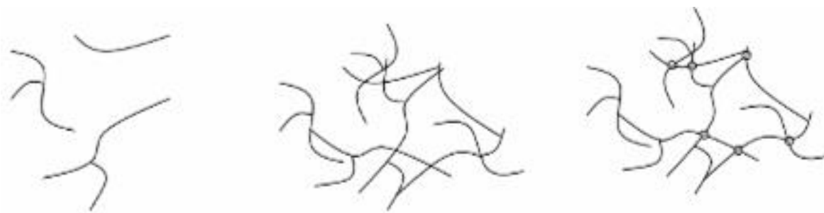
Figure 1.15 : Schéma acide : réaction puis oligomères
