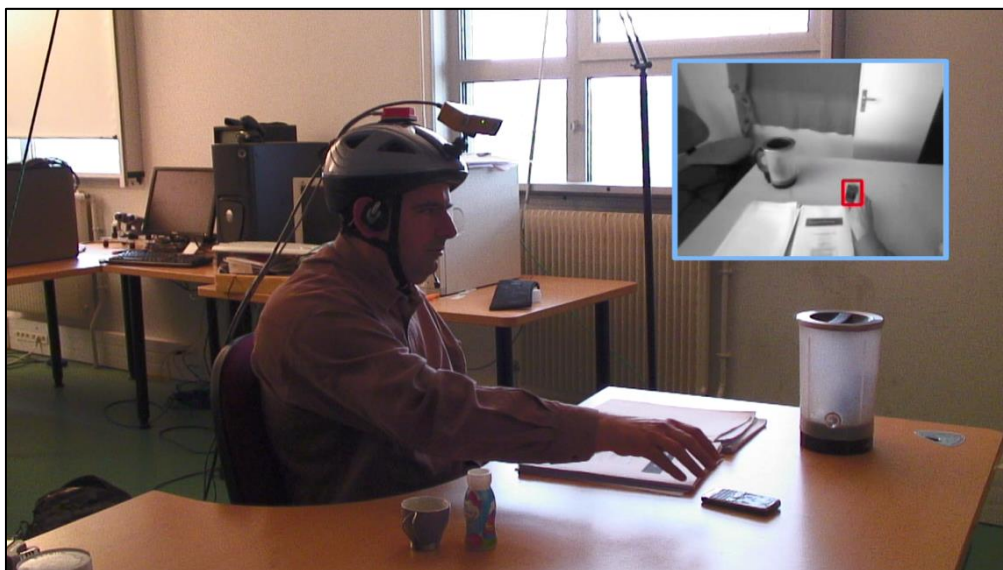
Figure II-20 Localisation et préhension d'objet. Le téléphone recherché est reconnu par le module de vision, et un son 3D est synthétisé à la position calculée par stéréovision.
