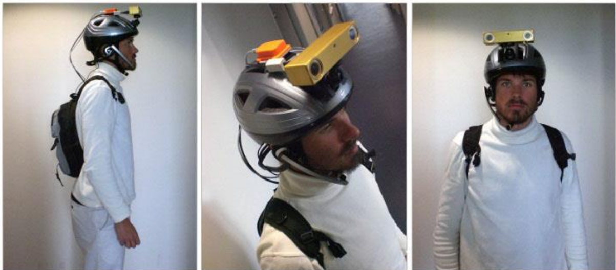
Figure II-2 Prototype Navig comprenant écouteurs, microphone, GPS, caméras stéréoscopique et centrale inertielle montés sur un casque ainsi qu'un ordinateur portable dans le sac à dos.
