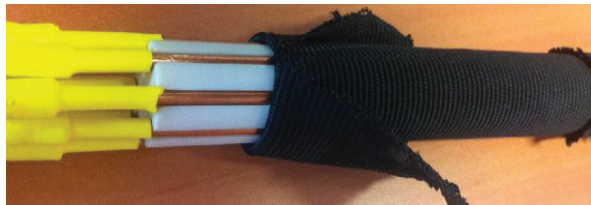
Figure 4.21 : Câble aux caractéristiques connus de huit conducteurs
