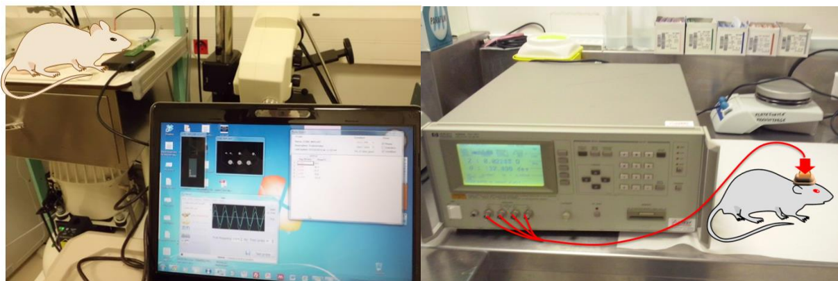
Figure 106 – Enregistrement in-vivo avec le NanoZ (gauche) ou avec un analyseur d'impédance de type LCRmètre (HP4284) (droite)
