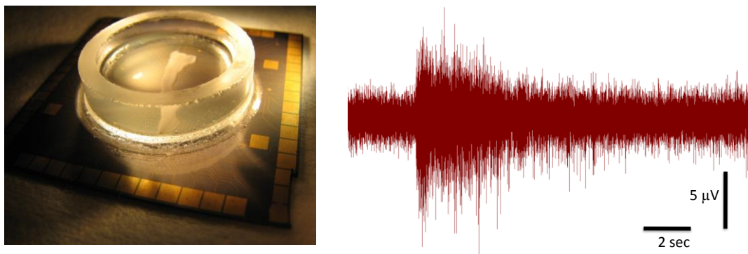
Figure 97 – Préparation d’une moelle épinière de rat sur une MEA diamant 4×15 (gauche) et enregistrement d’un potentiel d’action avec celle-ci (droite)
