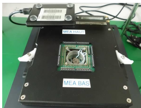
Figure 22 – MEA rigide connectée au NanoZ
