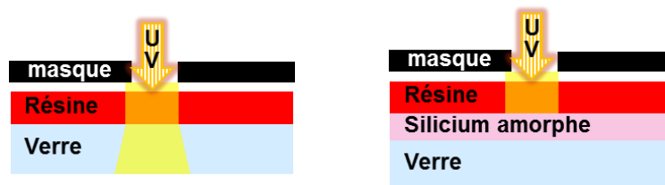
Figure 49 - Diffusion des UV dans le verre sans couche de revêtement (à gauche) et avec couche de revêtement (à droite).
