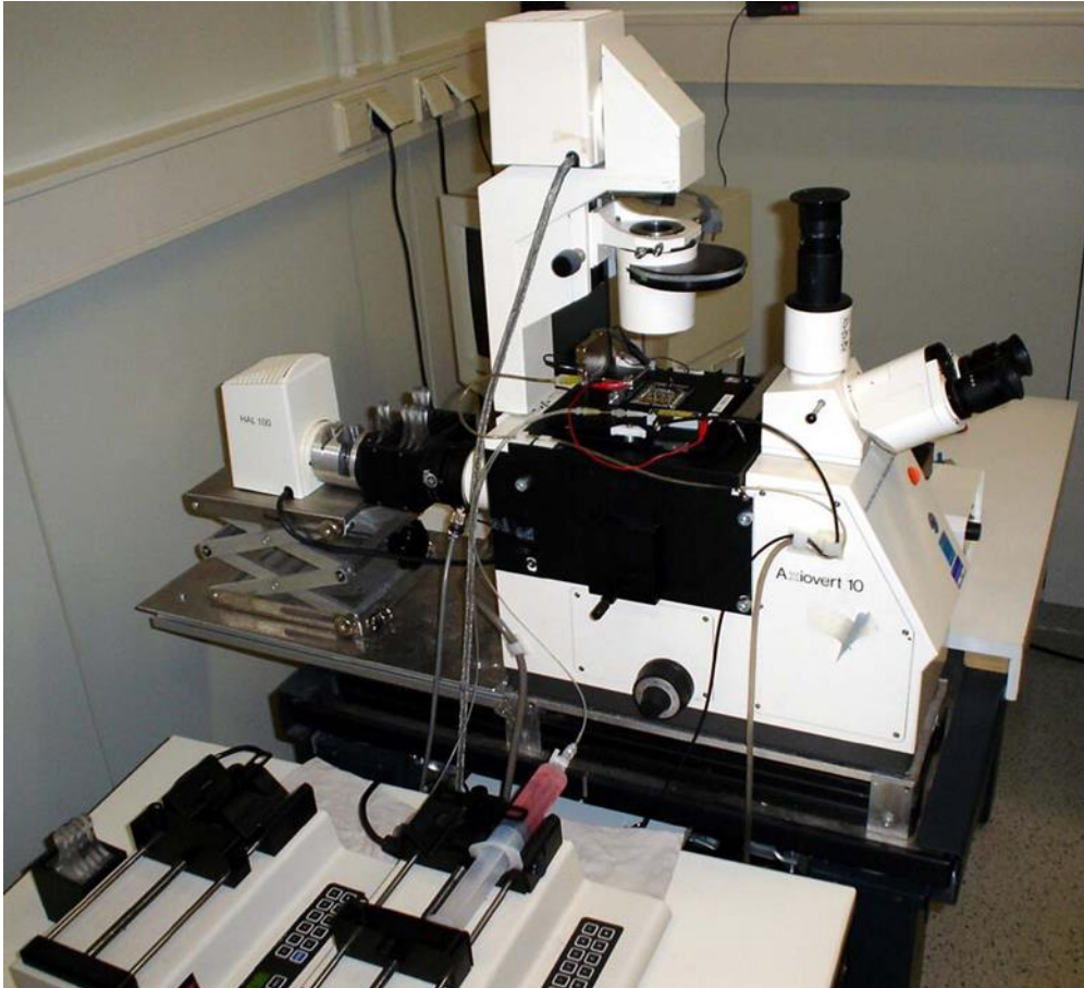
Figure 94 - Banc de mesure d'électrophysiologie pour l'enregistrement d'une rétine (IDV)
