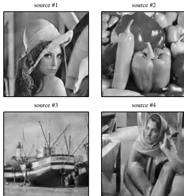
Figure V.17 – Exemple de reconstruction avec du \ell_1 repondéré (nGMCA-analyse repond., 16 observations, \text{SNR}_Y = 30\text{dB} , obtenant un \text{SDR}_S de 21.07dB).
