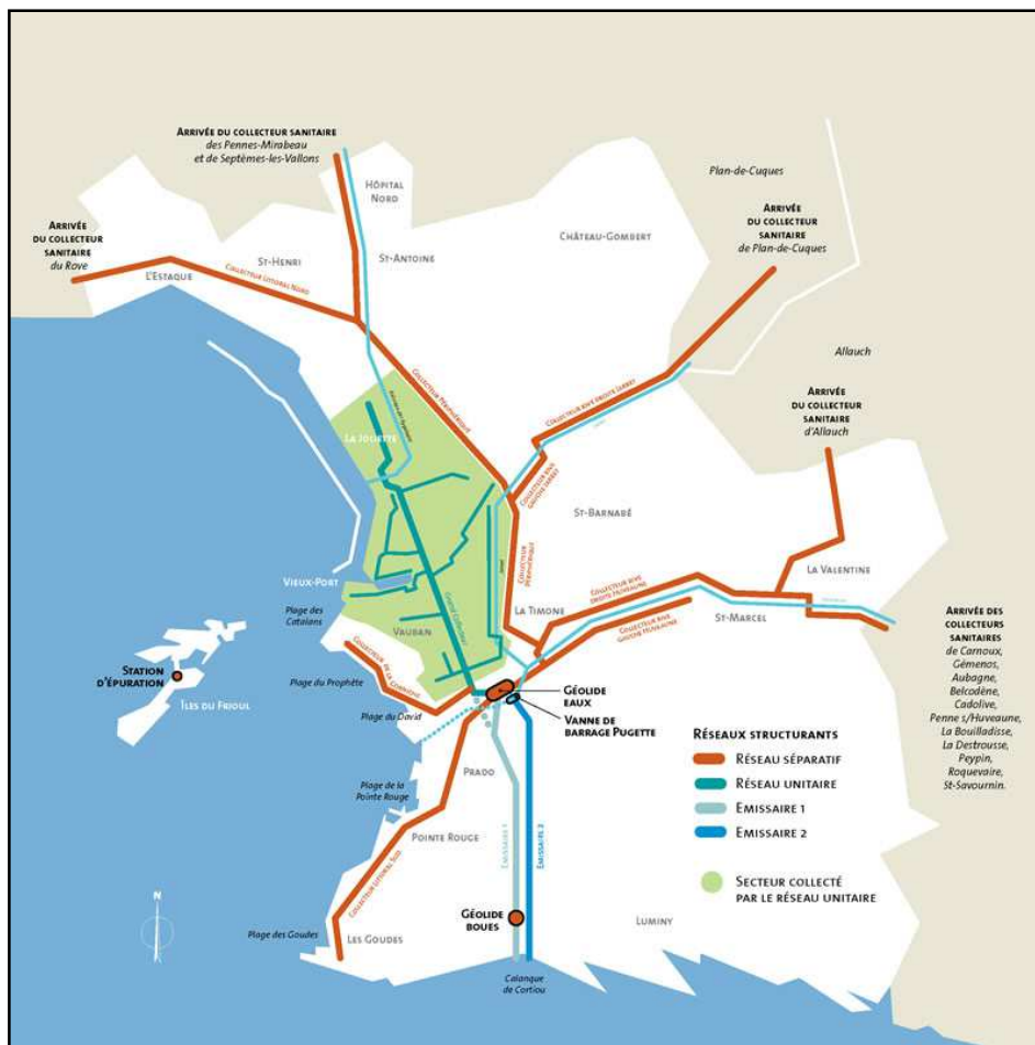
Figure II.1: Carte du réseau d'assainissement Marseillais (source SERAM).
