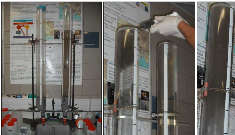
Figure II.13: Photographie du système employé dans l'étude de vitesse de chute des particules.
