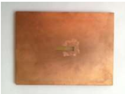
Figure 3-36. Patch réalisé sans Mutrak
