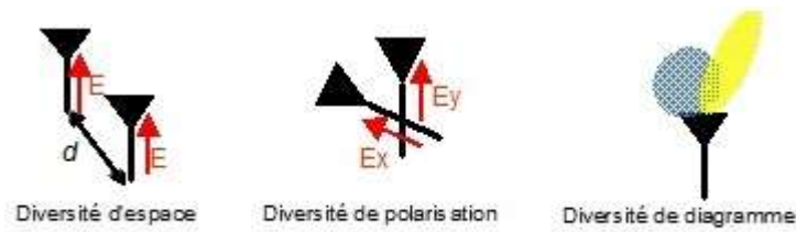
Figure 4-4. Les différentes techniques de diversité d'antennes
