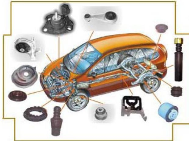
FIG. 4.1: Éléments en caoutchouc d'une automobile.
