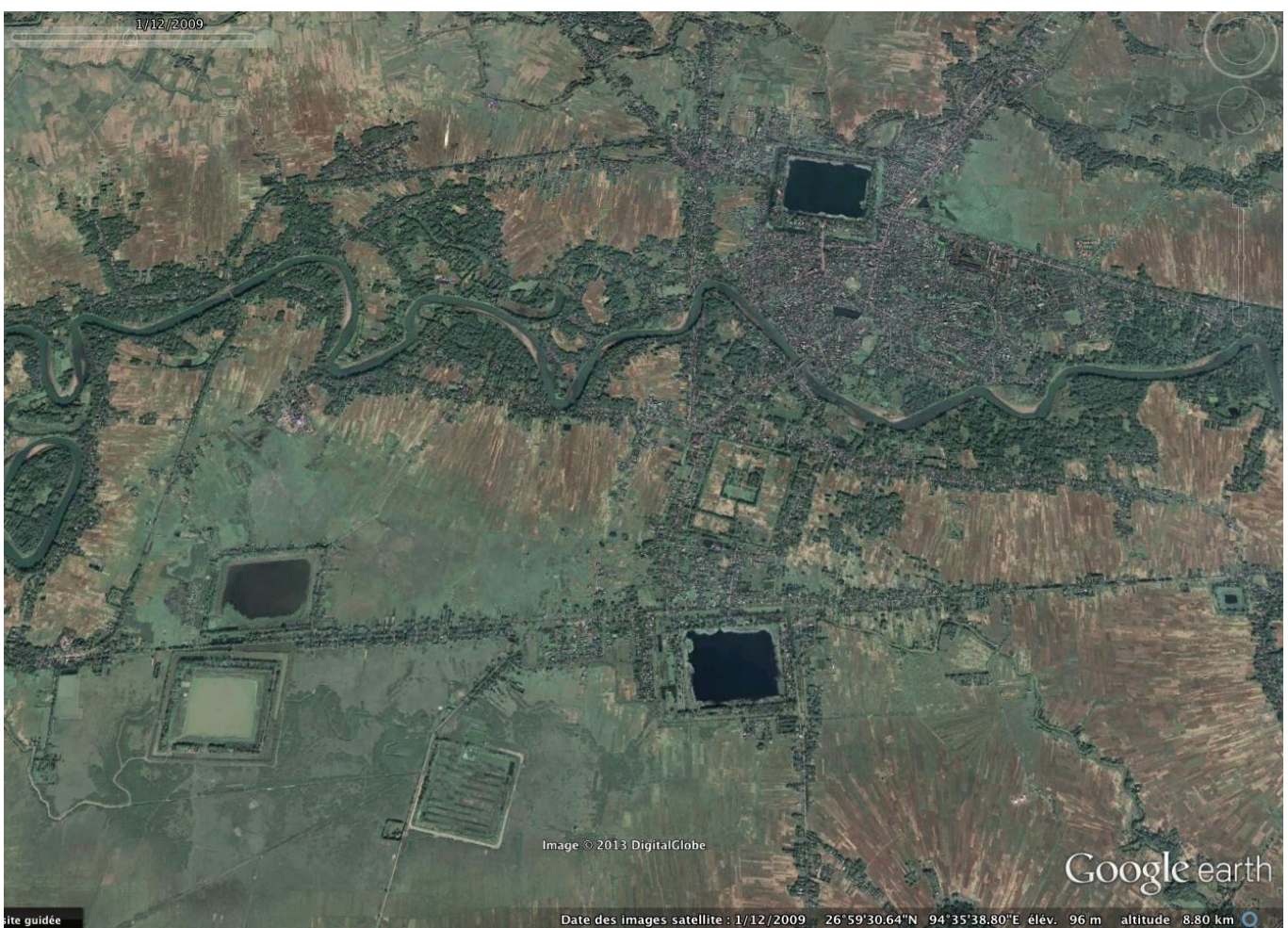
Photo 21 : Image satellite de Google earth sur laquelle on peut constater l'aménagement de grands réservoirs (couleur foncée) et l'installation des temples de Sivasagar (rive sud du Brahmapoutre) sur les plateformes (rectangulaires) reliées par des levées (servant de routes et de digues). Source : Google earth , 1/12/2009.
