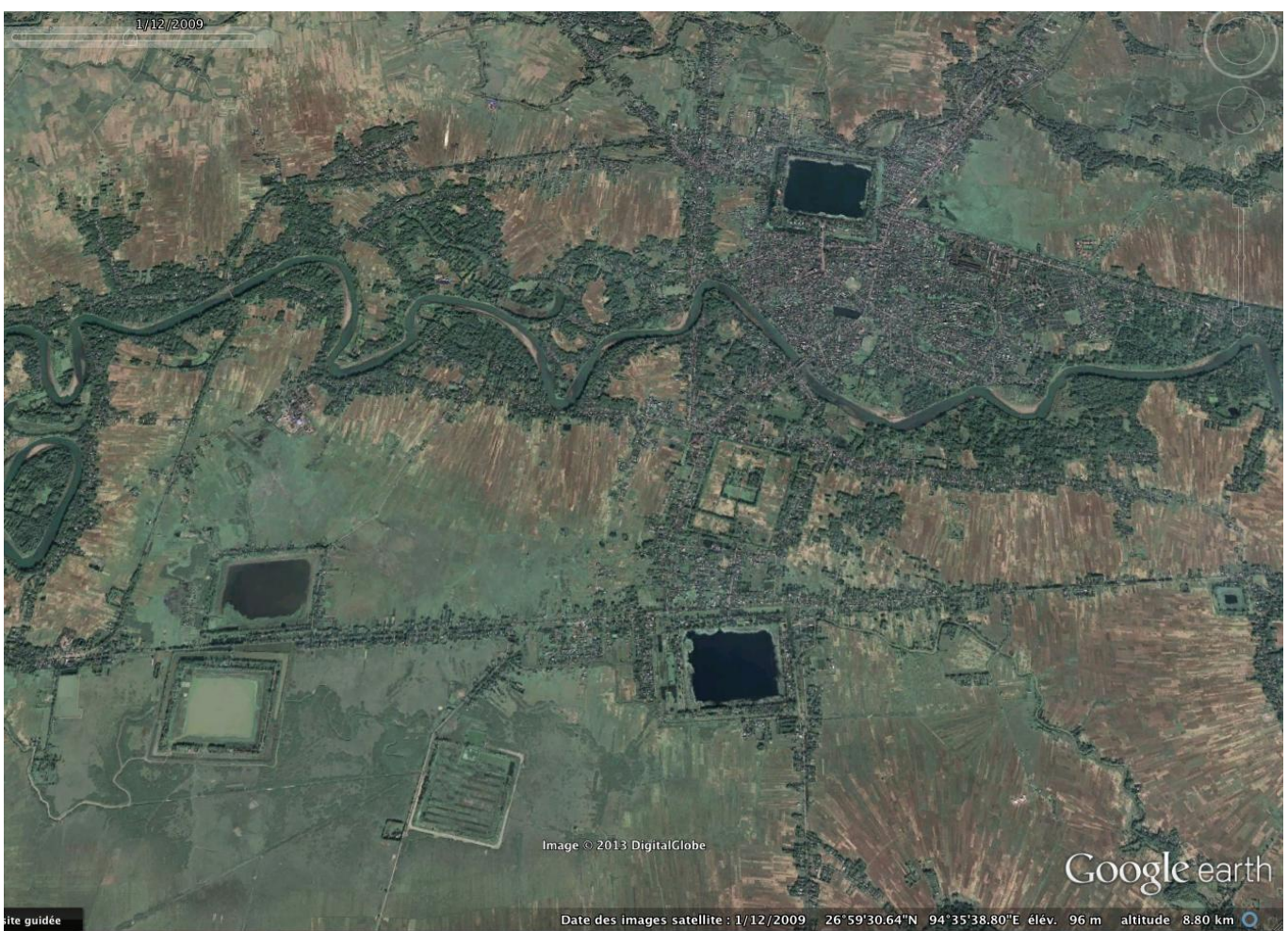
Photo 21 : Image satellite de Google earth sur laquelle on peut constater l'aménagement de grands réservoirs (couleur foncée) et l'installation des temples de Sivasagar (rive sud du Brahmapoutre) sur les plateformes (rectangulaires) reliées par des levées (servant de routes et de digues). Source : Google earth , 1/12/2009.
