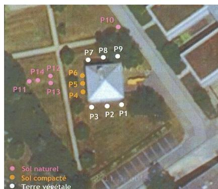
**Figure 4.5 : Les différents points de mesures**
