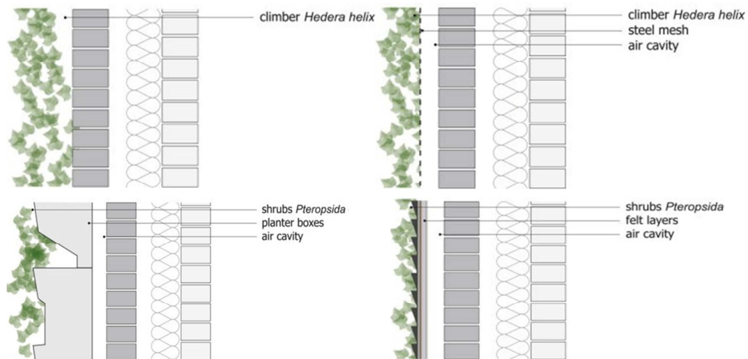
Figure 1-3 : Quatre types différents de façades végétalisées : (a) végétalisation directe ; (b) végétalisation indirecte ; (c) système de mur vivant avec modules de plantation ; (d) système de mur vivant avec une couche feutre hydroponique (source : (Ottelé et al., 2011))
