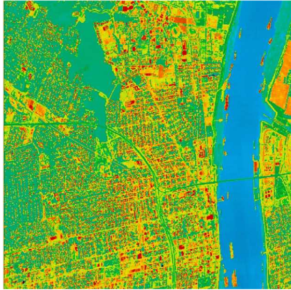
Figure 1-7 : Image thermique du centre-ville de Bâton Rouge en Louisiane prise le 11/05/1998 à 13h00 heure locale par un avion équipé par NASA. La température estimée varie entre 25°C pour la végétation et 65 °C pour les toitures (Gorsevski et al., 1998)
