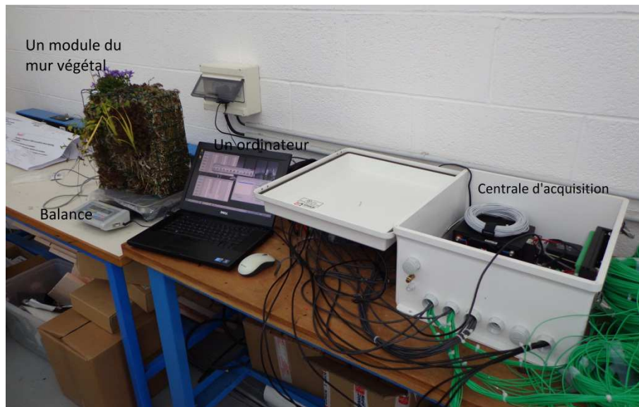
Figure 3-12 : Étalonnage des sondes de teneur en eau
