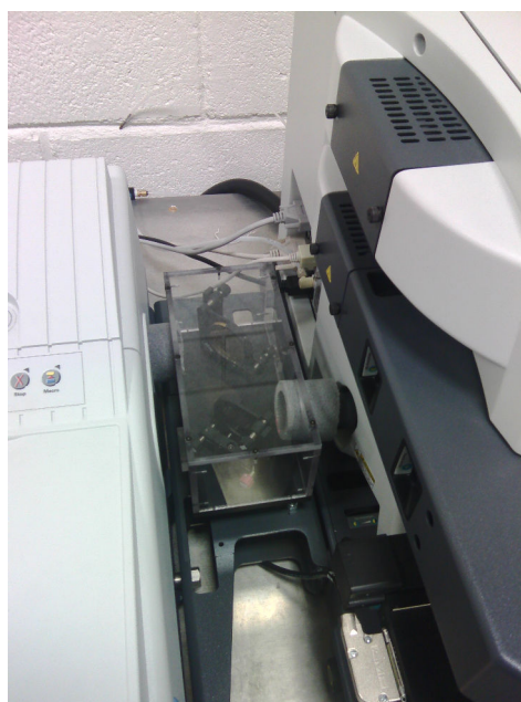
Figure 4.25 – Liaison périscopie pour coupler le microscope et le spectromètre en mode émission. les deux miroirs plans permettent de conserver le faisceau collimaté sortant du microscope et arrivant à l'entrée de l'interféromètre.
