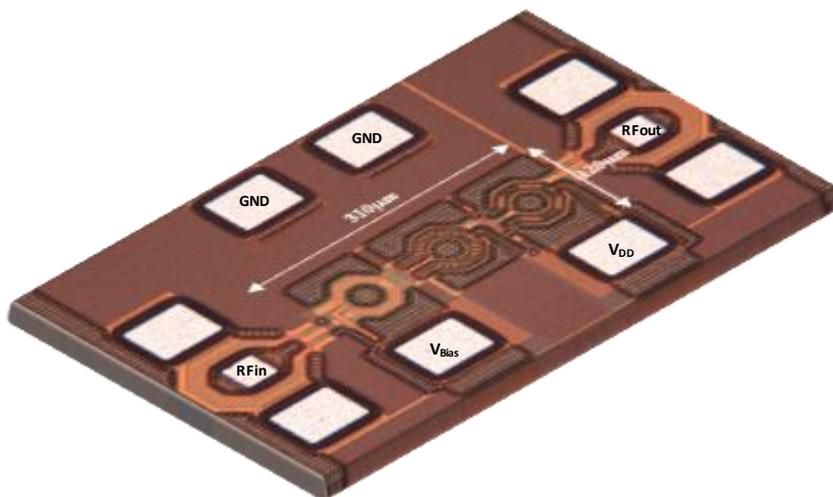
Figure III-50 : Photographie du PA CMOS 28nm Bulk
