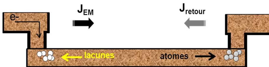
**Figure II-6** : flux d'électromigration et flux retour dans une interconnexion
